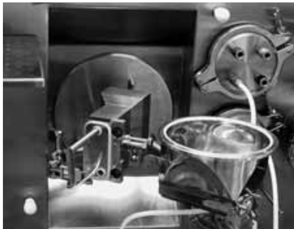
Abb. 9: Pharma-Doppeldosierschnecke in einem Isolator – demontierter Zustand
