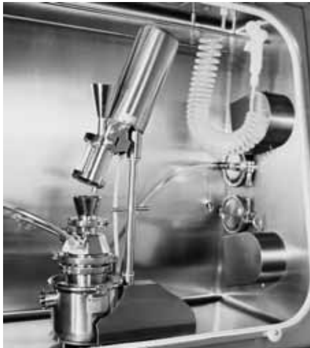
Abb. 3: Pharma-Mikrodosierer PMD in einem Isolator
