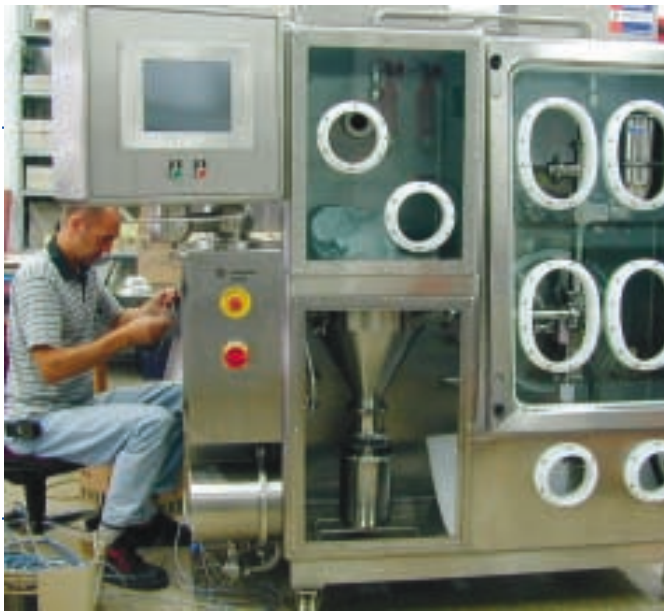
3: Endmontage eines Isolators mit integrierter Multiprozessanlage zum Feinmahlen und Sichten
