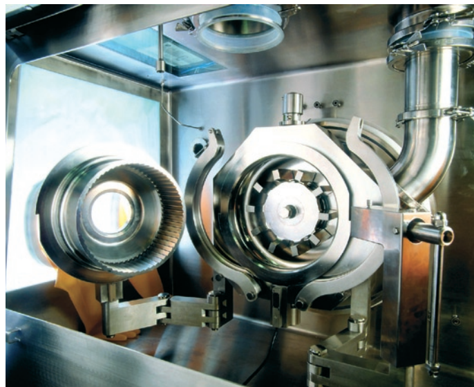
Diese neue Feinprallmühle 315 UPZ ist in einen Isolator integriert
