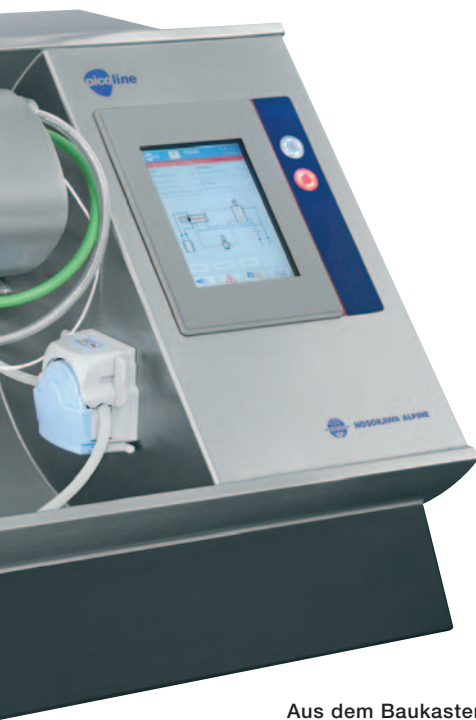
Aus dem Baukasten: Mischen, Sichten, Mahlen und mehr sind jetzt im Miniaturmaßstab möglich. Im Bild die Plattform mit Nass-Rührwerkskugelmühle und Rührer.
