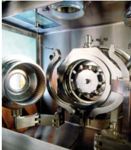
Abb. 3 & 4: Das Gesamtsystem muss ergonomisch ausgelegt sein. Hier eine Feinprallmühle (linkes Bild) und ein Dosierer mit Spiralstrahlmühle (rechts) im Isolator-Design.
