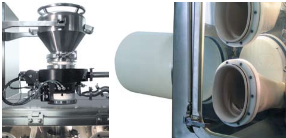
Abb. 1 & 2: Das passende Schleusenkonzept gewährleistet die sichere Prozessintegration des Isolators: Links die Produkteinschleusung über das Doppelklappensystem, rechts die Produktauserschleusung über einen Rapid-Transfer-Port.
