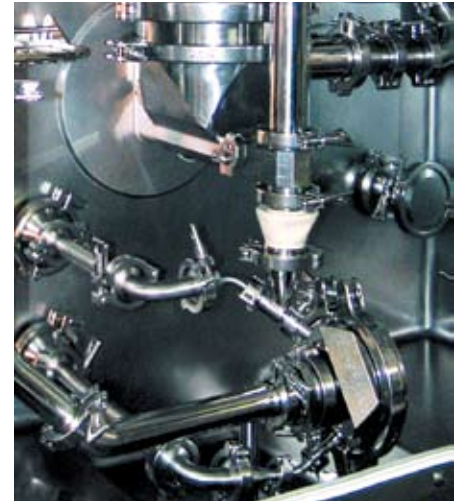
Abb. 3 & 4: Das Gesamtsystem muss ergonomisch ausgelegt sein. Hier eine Feinprallmühle (linkes Bild) und ein Dosierer mit Spiralstrahlmühle (rechts) im Isolator-Design.
