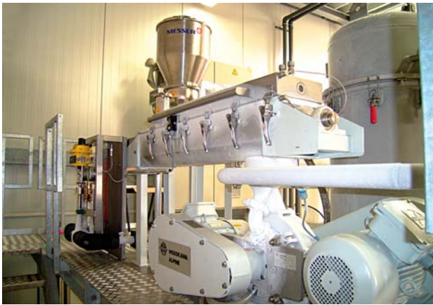
Bild 4: Zu Testzwecken kann mit der gegenläufigen Stiftmühle Hosokawa Alpine 160 C gearbeitet werden
