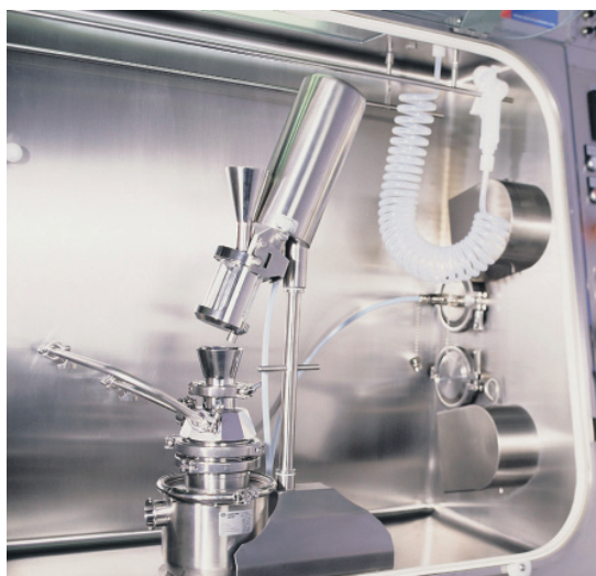
3: Pharma-Mikrodosierer PMD in einem Isolator
