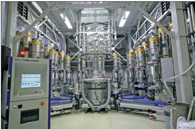
Eines der Highlights war die vorgestellte 9-Schicht-Anlage für Lebensmittelverpackungen Fotos: Hosokawa Alpine
