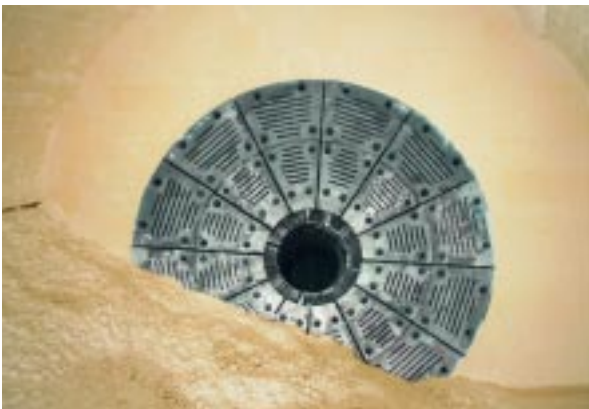
Bild 3 Blick in eine Kugelmühle für die Aufbereitung von technischer Keramik
